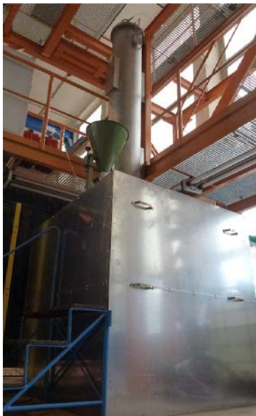
Abb. 3 Selektiver Aufschluss entlang von Korngrenzen durch einen Hochspannungs-Elektroimpuls
