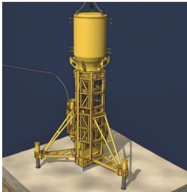
(1) Der Einsatz einer elektrisch betriebenen, vertikalen Bergbaueinheit zielt auf einen minimalinvasiven Ressourcenabbau in der Tiefsee ab. © BAUER Group
