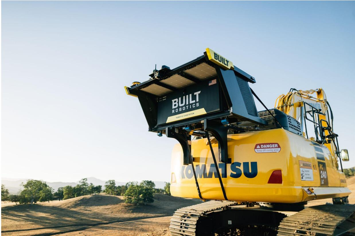
Das Exosystem kann auf der Rückseite von Baggern installiert werden, um sie in vollständig autonome Roboter zu verwandeln. Es verfügt über alle Sensoren und Technologien, die für die Integration in die jeweilige Baumaschine erforderlich sind.
