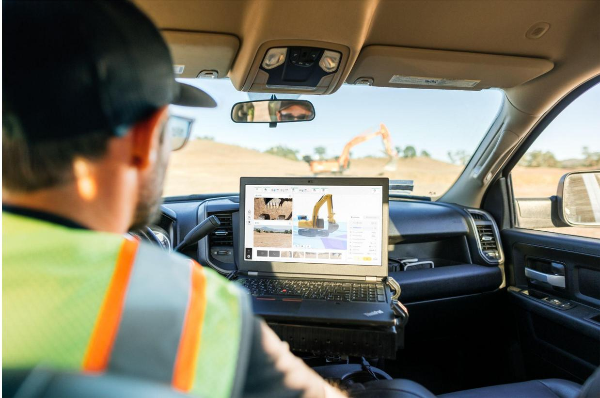
Ein leistungsfähiges und benutzerfreundliches Softwaresystem ermöglicht es einer neuen Kategorie von Mitarbeitern, dem Robotic Equipment Operator (REO), die Roboter aus der Ferne zu bedienen, während sich die Facharbeiter auf andere Aufgaben konzentrieren können. Auf diese Weise wird eine produktivere Belegschaft geschaffen, die sich auf wichtige Aufgaben konzentrieren kann, während gleichzeitig neue Aufgabenbereiche erschlossen werden, die es bisher im Bauwesen nicht gab.
