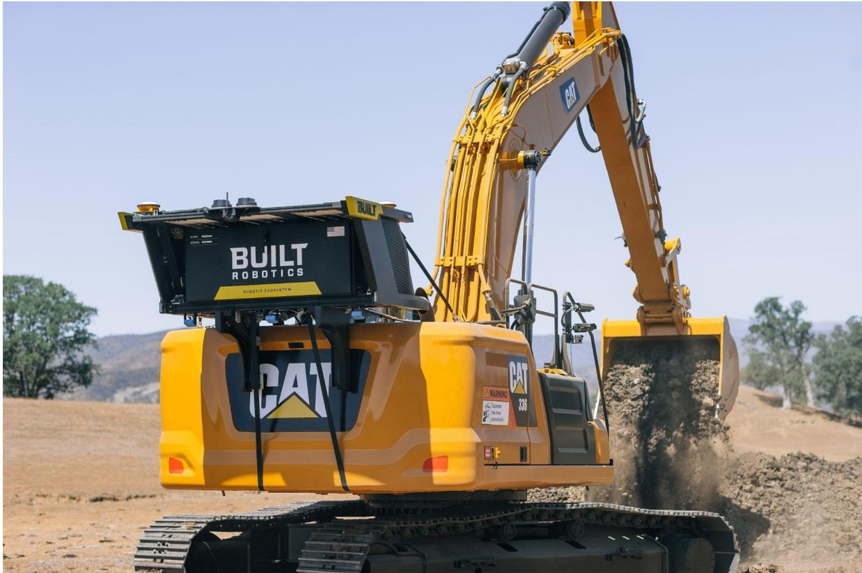
Ein auf der Rückseite eines Baggers installiertes Exosystem hebt selbstständig Gräben aus. Die Technologie von Built kann auf den meisten schweren Nutzfahrzeugen einer Vielzahl von Herstellern installiert werden.
