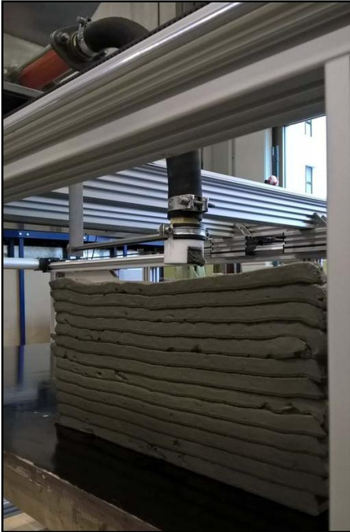
Bild 2: Beton-3D-Druck im Laborversuch
